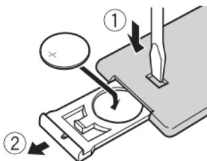
Setzen Sie die CR2025-Batterie (3 V) so ein, dass Plus-(+) und Minuspol (-) richtig ausgerichtet sind.
