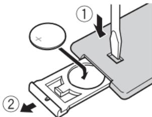
Inserire la batteria CR2025 (3 V) con i poli positivi (+) e negativi (-) orientati correttamente.
