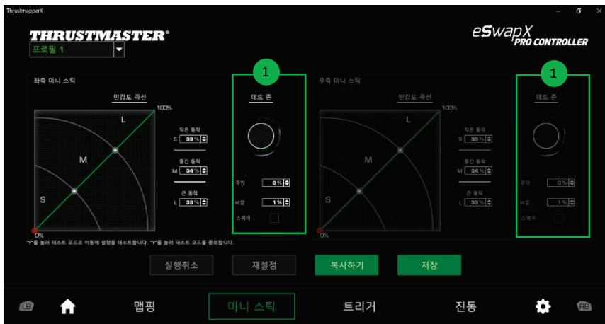
테스트 모드에 들어가 설정을 시험해 보려면 게임패드에서 Y 버튼을 누르고 미니 스틱을 이동하십시오. 테스트 모드를 종료하려면 게임패드의 Y 버튼을 다시 누르십시오.
