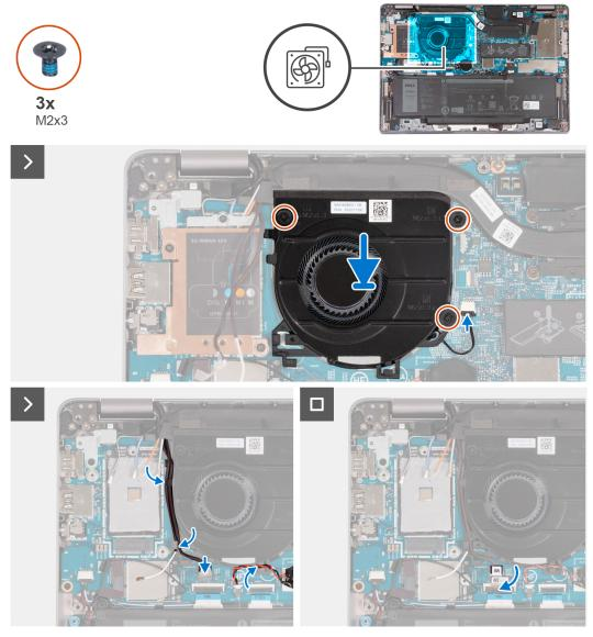
Figure 35. Install the fan
